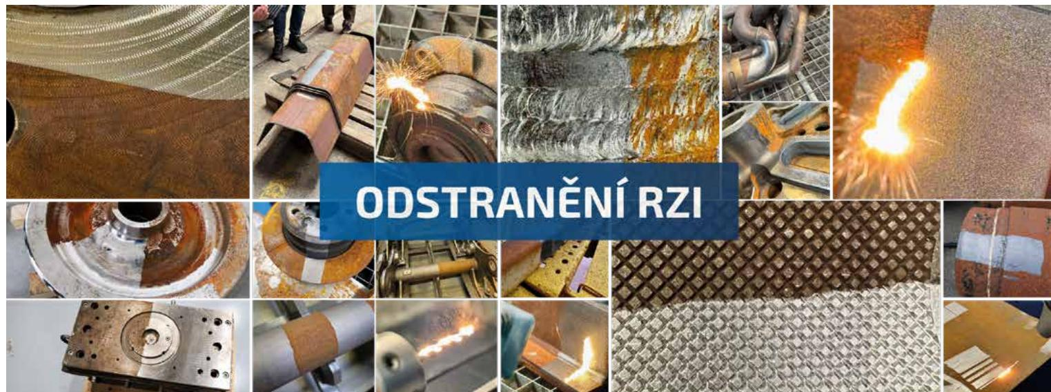
**Odstranění rzi:** Čisticí lasery jsou ideální pro odstraňování rzi z ocelových konstrukcí, strojních dílů, nástrojů, trubek a dopravních prostředků. Tato metoda je rychlá, nepoškozuje podkladový materiál a eliminuje potřebu abrazivních nebo chemických procesů.
