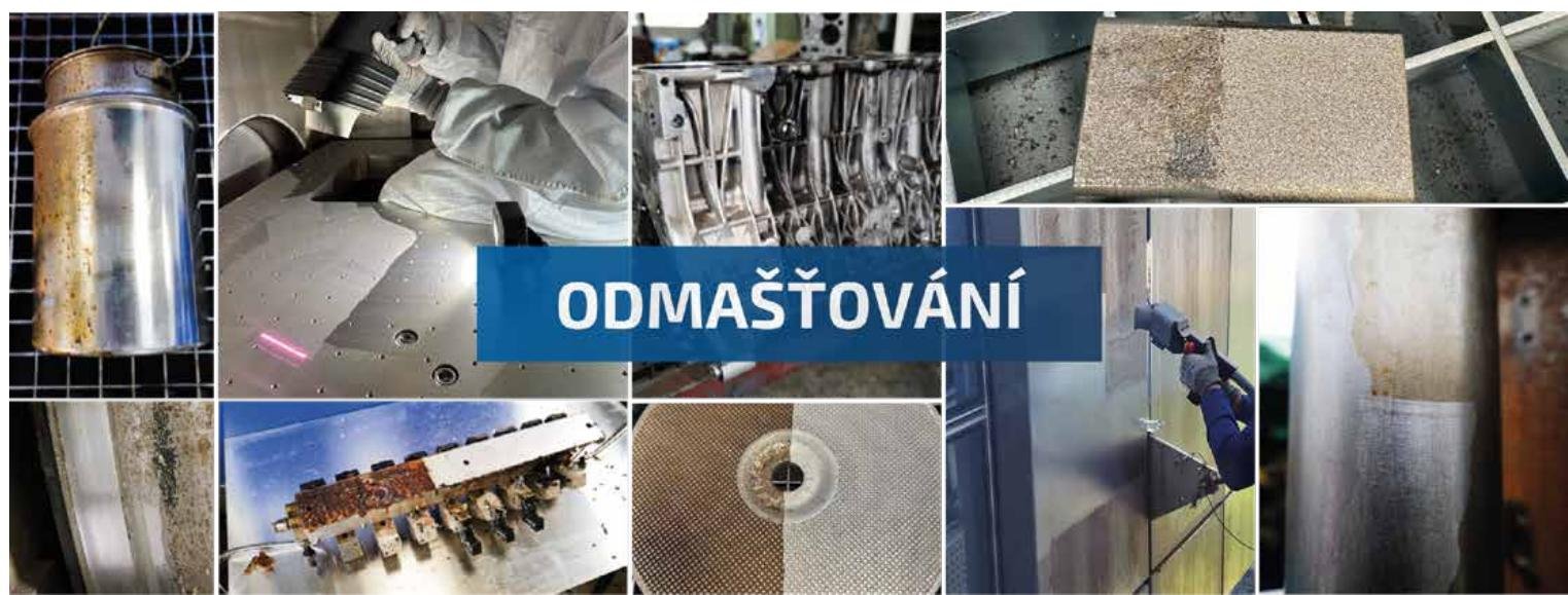
**Odmašťování:** Lasery se často používají k odstraňování olejů, maziv a jiných mastných nečistot z povrchů automobilových dílů, součástí strojů a nástrojů. Tím připravují díly na další zpracování, jako je svařování, lakování nebo lepení.
